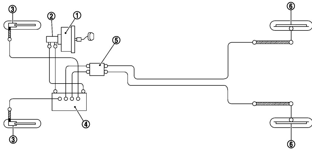
1. 制动助力器                          2. 主缸总成
